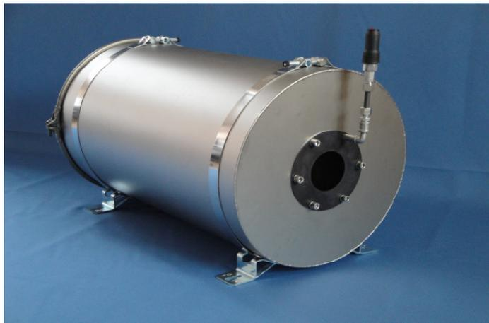
Der Anschluss für Abgaseintritt und Abgasaustritt hat einen Durchmesser von 90 mm oder 110mm. Der Abgaseintritt ist die mit dem Filtergehäuse verschweißte Stirnseite. Die Flansche an Abgaseintritt und Abgasaustritt, zur Verbindung mit der Abgasleitung, sind aus ST 37 und gehören mit den Dichtungen zum Lieferumfang.
